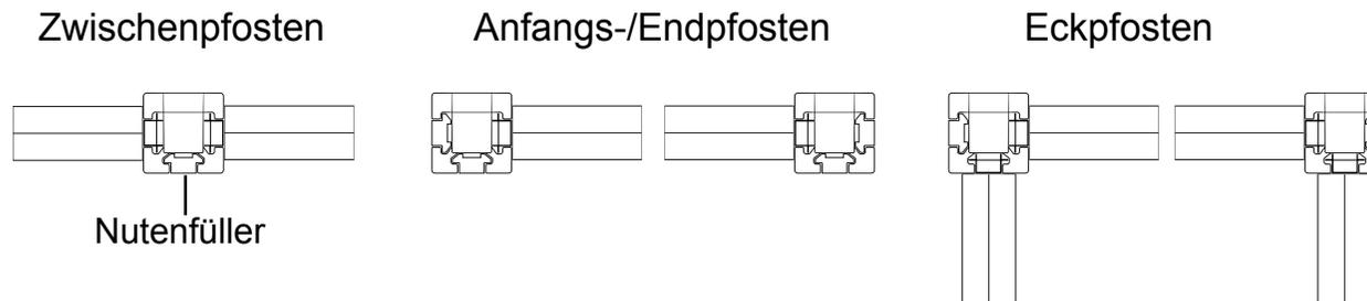
Sie können auch jederzeit einen **Nutenfüller** entnehmen und in eine andere Kammer schieben. Dies ist Ihnen frei überlassen. So können Sie beispielsweise aus einem Zwischenpfosten einen Eckpfosten machen.
